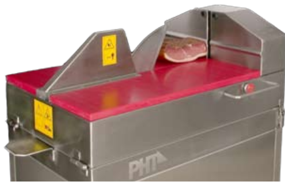
Zweihandbedienung und optische Überwachung gewährleisten optimale Sicherheit
