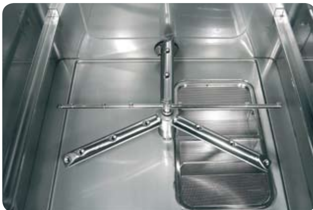
Große herausnehmbare Filterflächen machen die Pflege ganz einfach.
